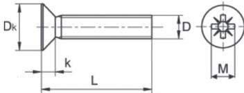
Винт с метрической резьбой. Применяется для крепления взенкованное отверстие с метрической резьбой. Требуется предварительное сверление и нарезание резьбы соответствующего размера. Класс прочности 4.8. Цинковое покрытие.
