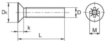
Винт с метрической резьбой. Применяется для крепления в зенкованное отверстие с метрической резьбой. Требуется предварительное сверление и нарезание резьбы соответствующего размера. Класс прочности 5,8.
